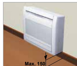
Laag aan de wand
